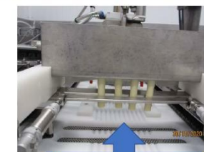
Шланги подачи бульона вставляются в просвет зажима шланга для бульона.
