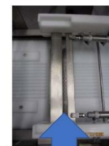
Убедитесь, что зажим шланга для бульона находится в открытом положении, так чтобы стала возможной установка желоба для бульона.
