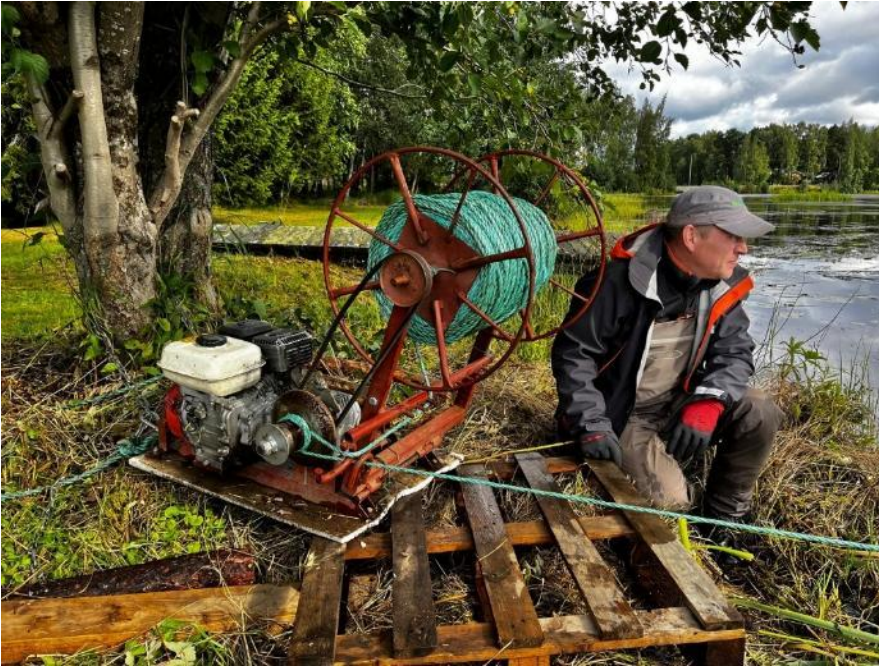
Kuva 5. Kelukoneen käyttöä. Kelukoneen vihreä köysi on kiinni nuotassa, kelausta pitää aktiivisesti seurata ja tarvittaessa lisätä tai vähentää kelausnopeutta.
