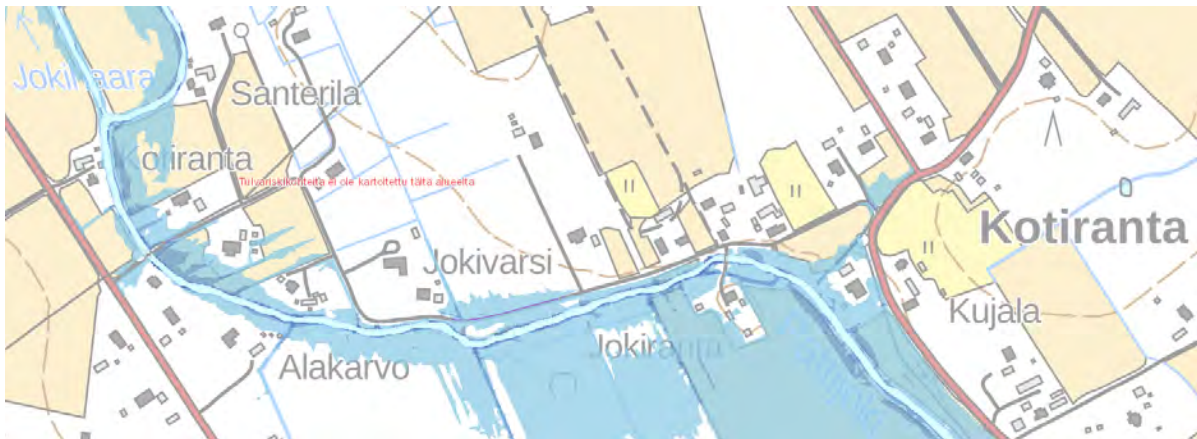
Kuva 4-3. Katkeavat tieosuudet, kun tulva alueella korkeudella +2,4...3 m. Alueella suojattiin lukuisia rakennuksia 13.10.2023 tulvalla.
