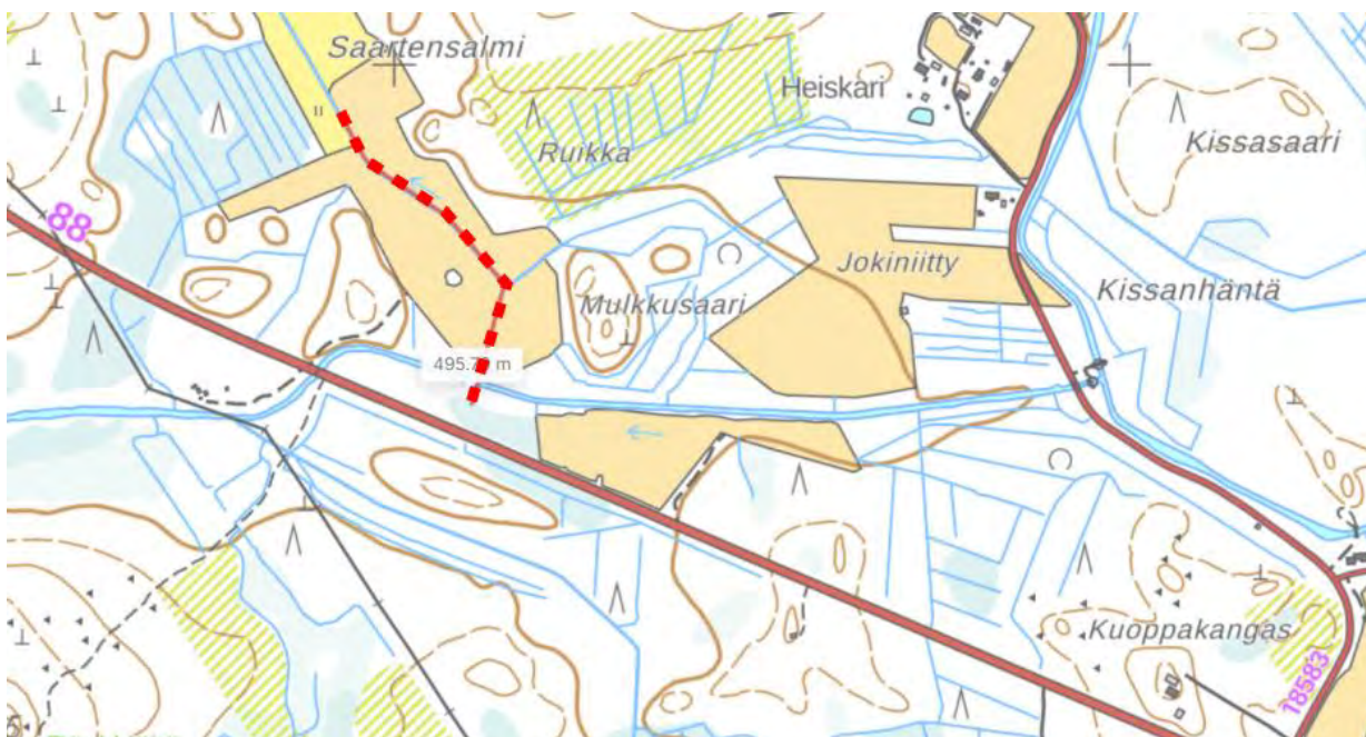
Kuva 1-1: Uusi yhteys täyttökanavasta Ruonanojaan ja Lappasenojaan. Yhdyskanavan pituus noin 140 m, minkä lisäksi mahdollisesti tarvitaan uoman vähäistä syventämistä noin 250...400 m matkalla.
