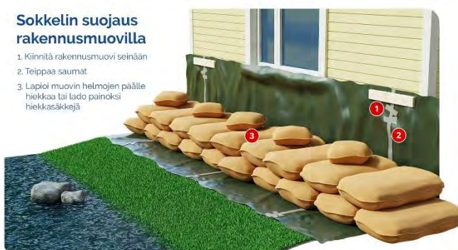
Kuva 4-1. Tilapäisen tulvavallin rakentaminen ja rakennuksen suojaaminen muovin sekä hiekkasäkkien avulla (kuvat Vesi.fi).
