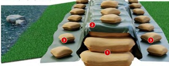
Kuva 4-1. Tilapäisen tulvavallin rakentaminen ja rakennuksen suojaaminen muovin sekä hiekkasäkkien avulla (kuvat Vesi.fi).
