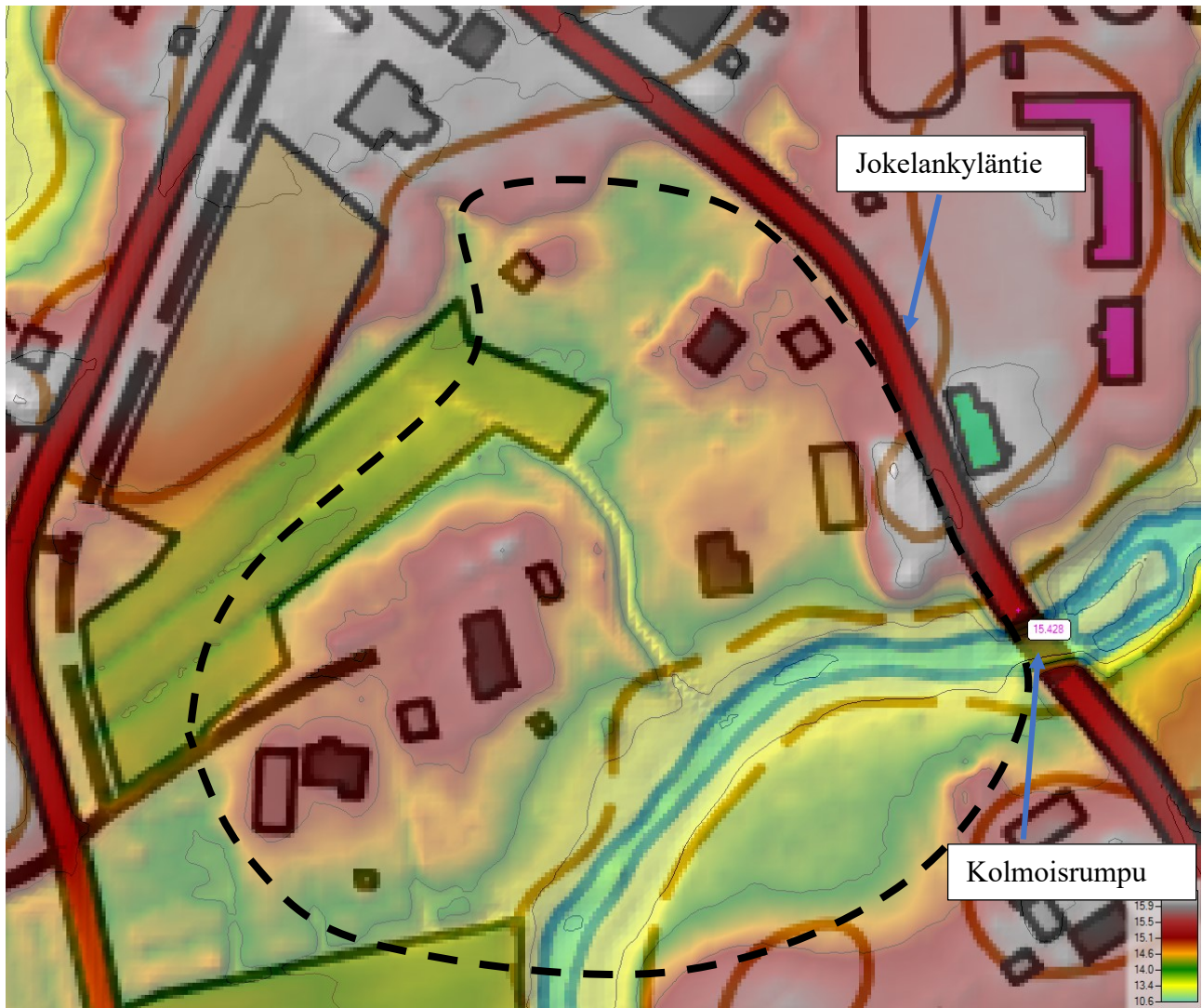
Kuva 17. Jokelankyläntien kolmoisrummun tukkeutuminen nostaisi veden ja uhkasi mustalla katkoviivalla merkittyjä rakennuksia. Kuvassa tiekorkeus maastomallista N2000+. Taustakartta sisältää Maanmittauslaitoksen aineistoa 09/2022.
