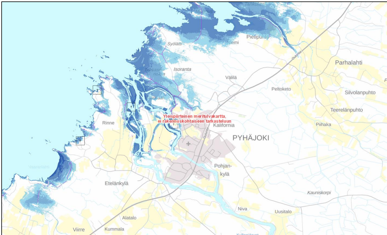
Kuva 24. Meritulvan yleispiirteinen tulvakartta 1/20 a toistuvalla vedenkorkeudella Pyhäjoen kohdalla. Lähde: Tulvakarttapalvelu.
