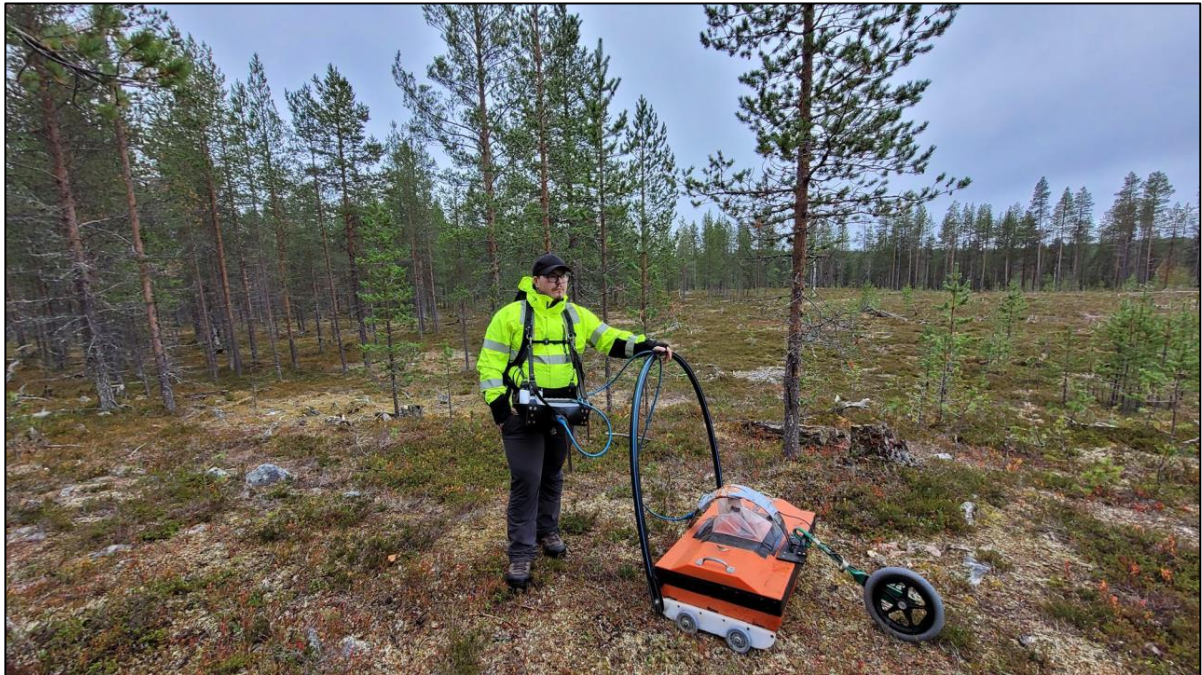
Kuva 1. Tietömillä kohteilla maatutkaluotausta voidaan tehdä perässä vedettävällä laitteistolla. (kuva: Geo-Work Oy)
