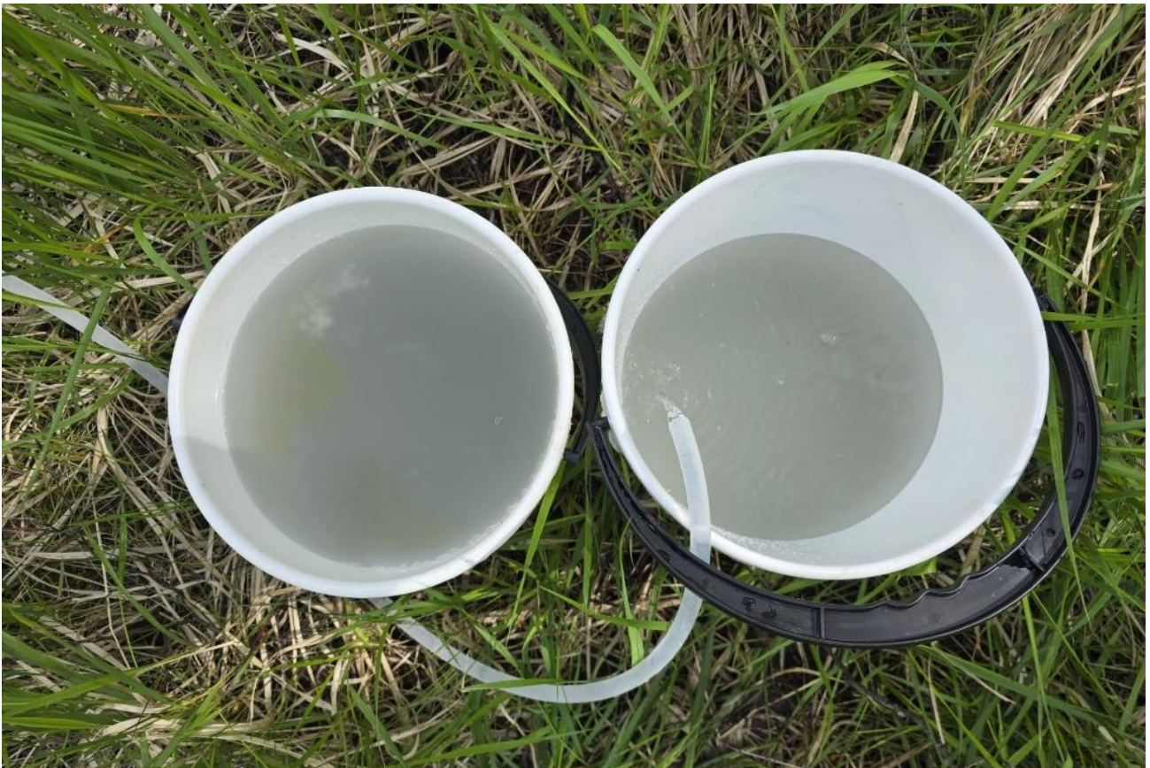
Kuva 2. PVP1 pumpattu vesi on ollut harmaata ja sameaa
