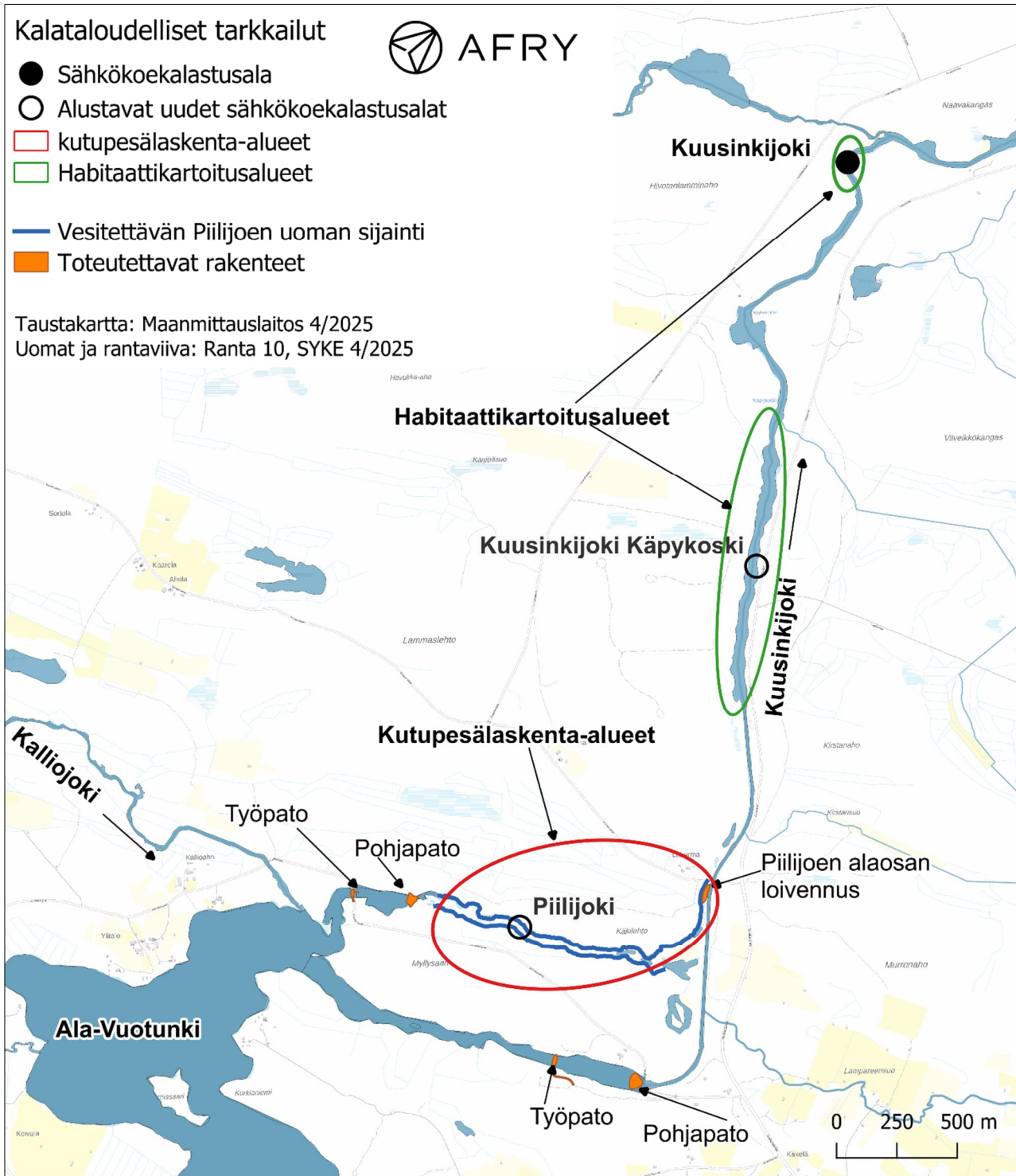
Kuva 2. Hankkeen kalataloustarkkailun tarkkailualueet sekä hankkeessa toteutettavat rakenteet Kuusinkijoen yläkanavaan sekä Piilijokeen. Piilijoen uoman suuntaa antava raja on merkitty karttaan sinisellä.
