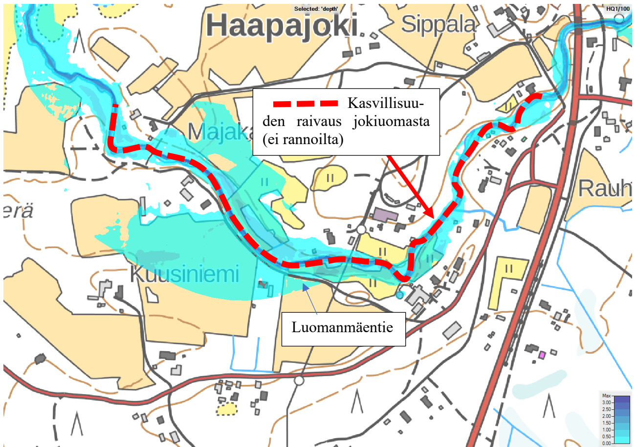
Kuva 41. Haapajoen alaosalta raivattavan kasvillisuuden alue joen uomasta, kuvassa HQ1/100 tulva. Huom.! Kuusiniemen alueelle vettä ei ohjautu 1D laskennan osoittamaa määrää, vaan alue jää rajatummaksi osin Luomanmäentien ja Kuusiniemen alueen maanpinnan muotojen ansiosta. Taustakartta Maanmittauslaitos 09/2022.
