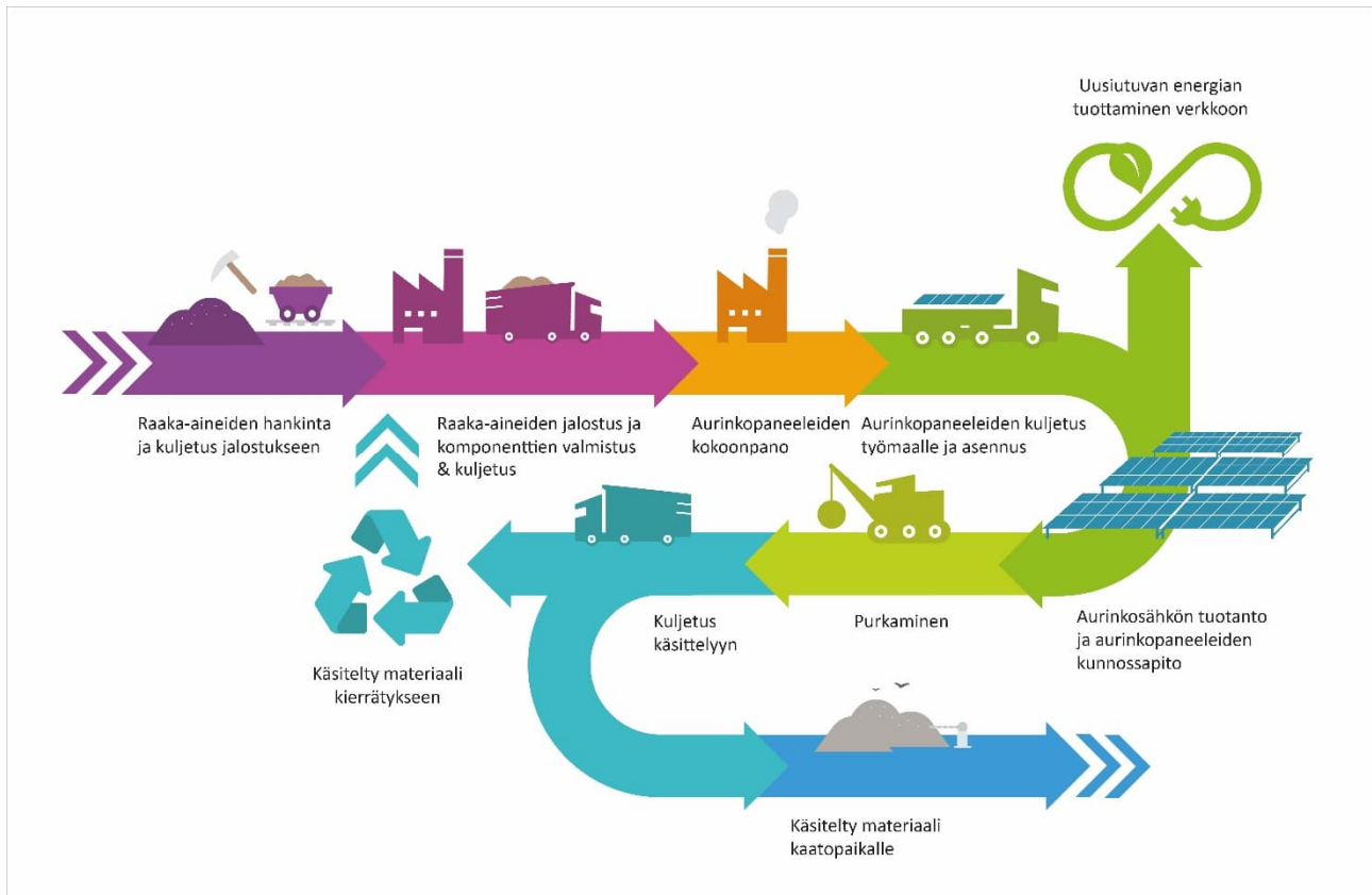
Kuva 56. Aurinkopaneelien yksinkertaistettu elinkaari.
