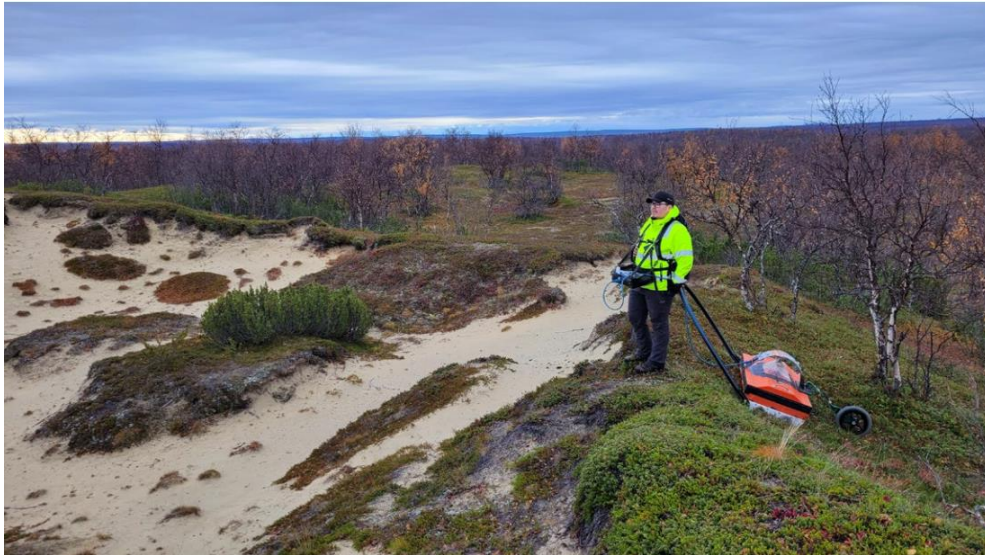
Kuva 1. Tiettömillä kohteilla maatutkaluotausta voidaan tehdä perässä vedettävällä laitteistolla. (kuva: Geo-Work Oy)
