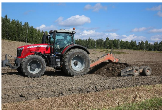
För utjämningsladdning behövs mycket data om åkerns yta, bra planer och en kraftfull traktor som drar sladden.
