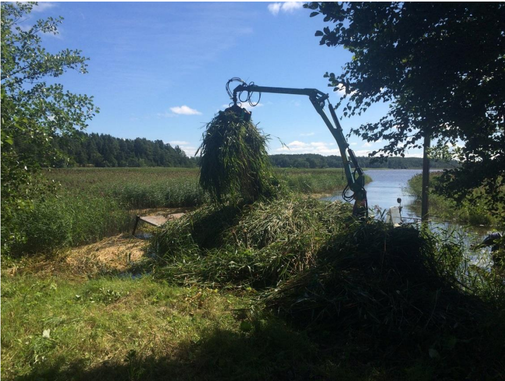
Kuva 2. Kalastusproomun avulla ruoko saatiin kuljetuksen lisäksi nostettua maihin, joten erillistä konetta ei tähän tarkoitukseen vaadittu. Kuva: Maria Yli-Renko.
