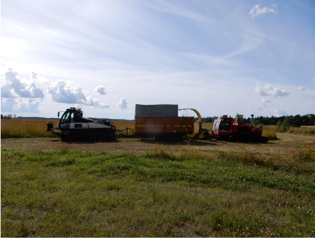
Kuva 3. Ruokopelto-hankkeessa maaruovikoita leikattiin rinnekone-kaksoissilppuriyhdistelmällä, joka leikkaa, kerää ja silppuaa ruo'on. Kuva: Maria Yli-Renko.
