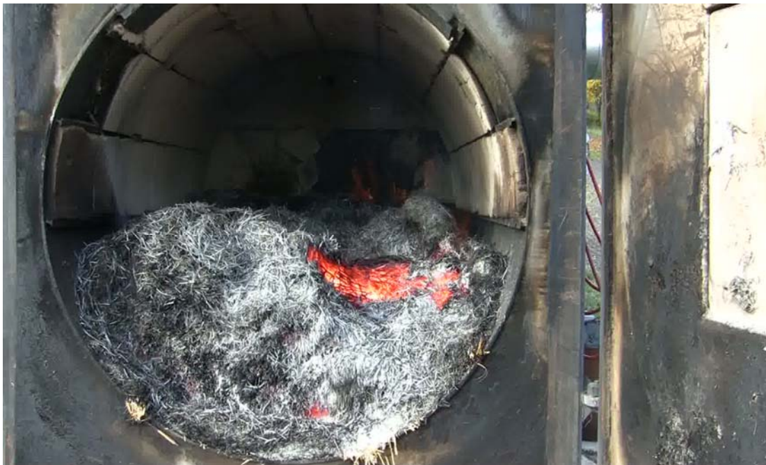
Kuva 23. Järviruo'osta jäi selvästi enemmän tuhkaa jäljelle kuin oljesta. Tämä olisi palanut vähemmäksi, jos kattilan automaatiikka ei olisi katkaissut palotapahtumaa turhan aikaisin. (Kuva: Kari Vuorio, TTS tutkimus)
