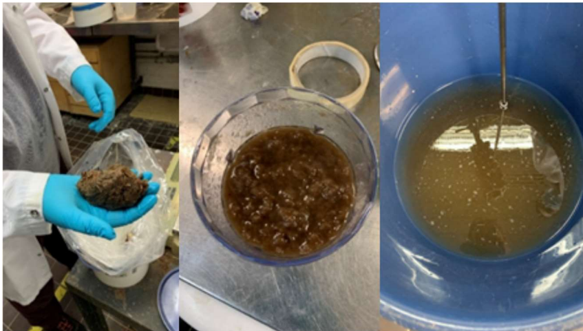
Kuva 2. Järviruo'on kuidut eri vaiheissa. Ennen paperin valmistusta. Kuitupallo, kuitupuuro ja kuituliemi.
