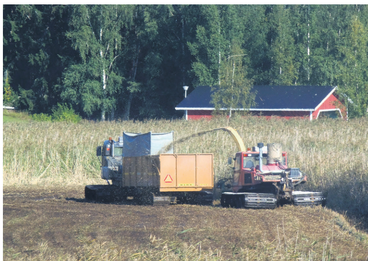
Ruokopelto-hankkeen rannalta tapahtuva leikkuu tehdään tarkoitusta varten kehitetyllä rinnekone-kaksoissilppuri -yhdistelmällä.
