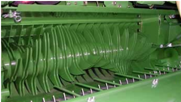
Kuva 7. Krone-pyöröpaalaimen silppuri (Agrimarket [viitattu 16.2.2007]).
