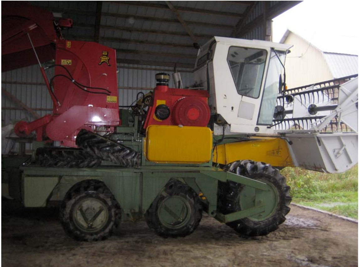
Kuva 14. Ruokopuimurin etuvaunu, jossa näkyvät leikkuupöytä, kolakuljetin ja pyöröpaalain. (Timo Himanen, sähköpostiviesti 20.2.2007.)
