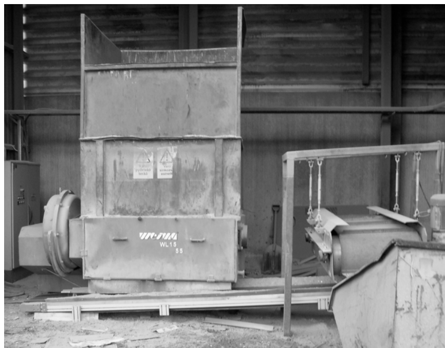
Kuva 21. Weima 15/55 murskain, murskankuljetus rata ja magneettierotin.
