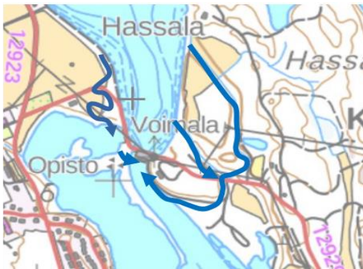
Kuva 1: Ohitusuomia Kolsin vesivoimalaitoksen kohdalla
