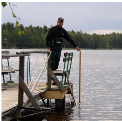
Kuva 4. Pohjapaalu Valkiajärvellä. Jos rannasta ei löydy asteikolle sopivaa paikkaa, voidaan vedenkorkeus mitata pohjapaalun avulla. Tällöin järven pohjaan asennetaan paalu, ja vedenkorkeus mitataan erillisen mittakepin (ns. suppilomitta; kuvassa) avulla.
