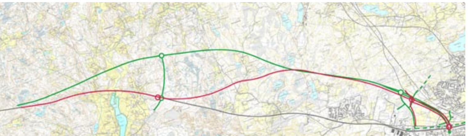
Kuva 10. Soppeenmäki – Sarkkila yleissuunnitelmassa 1994 tutkittu linjausvaihtoehto (vihreä) sekä Ylöjärvi – Vaasa kehittämissuunnitelmassa 2005 esitetty uusi lyhyt linjaus (punainen)
