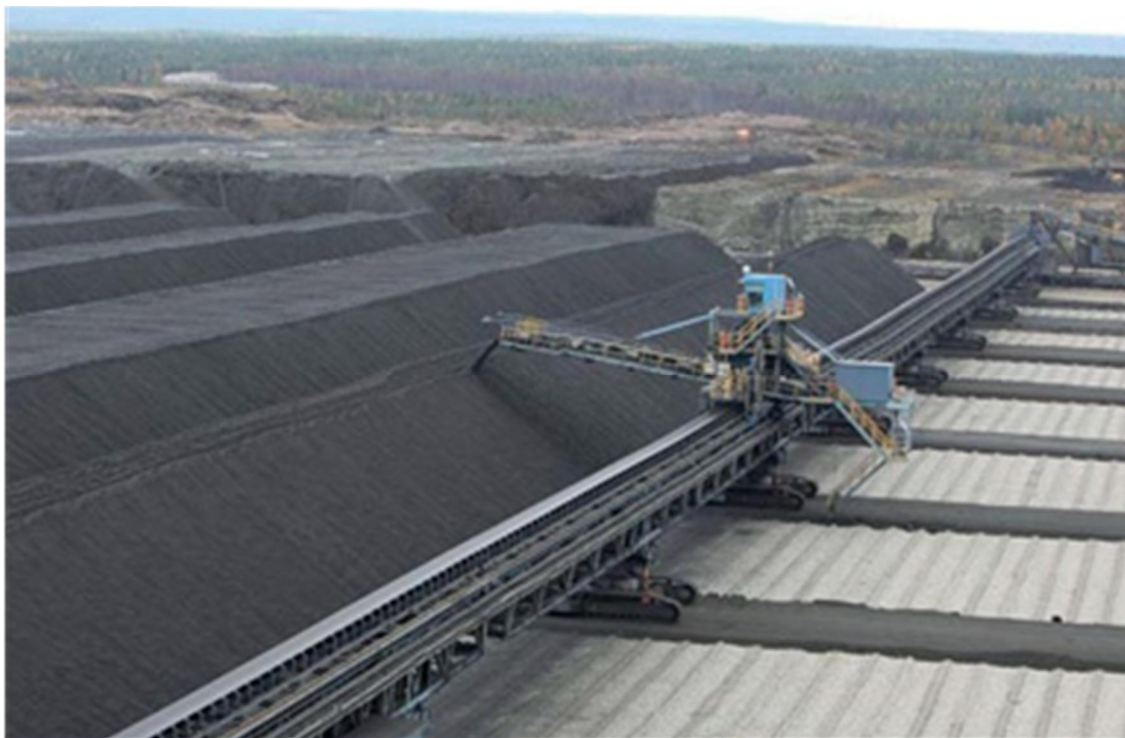
Kuva 3-7. Primääriliuotuskasan täyttö sähkökäyttöisellä kasauslaitteistolla (ns. stakkerilla) (Ramboll Finland Oy 2012).
