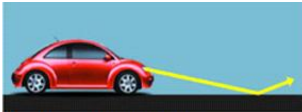
Светоотражающий эффект дорожной разметки без стеклошариков
