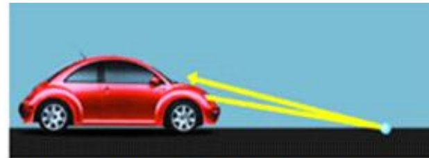
Светоотражающий эффект дорожной разметки со стеклошариками
