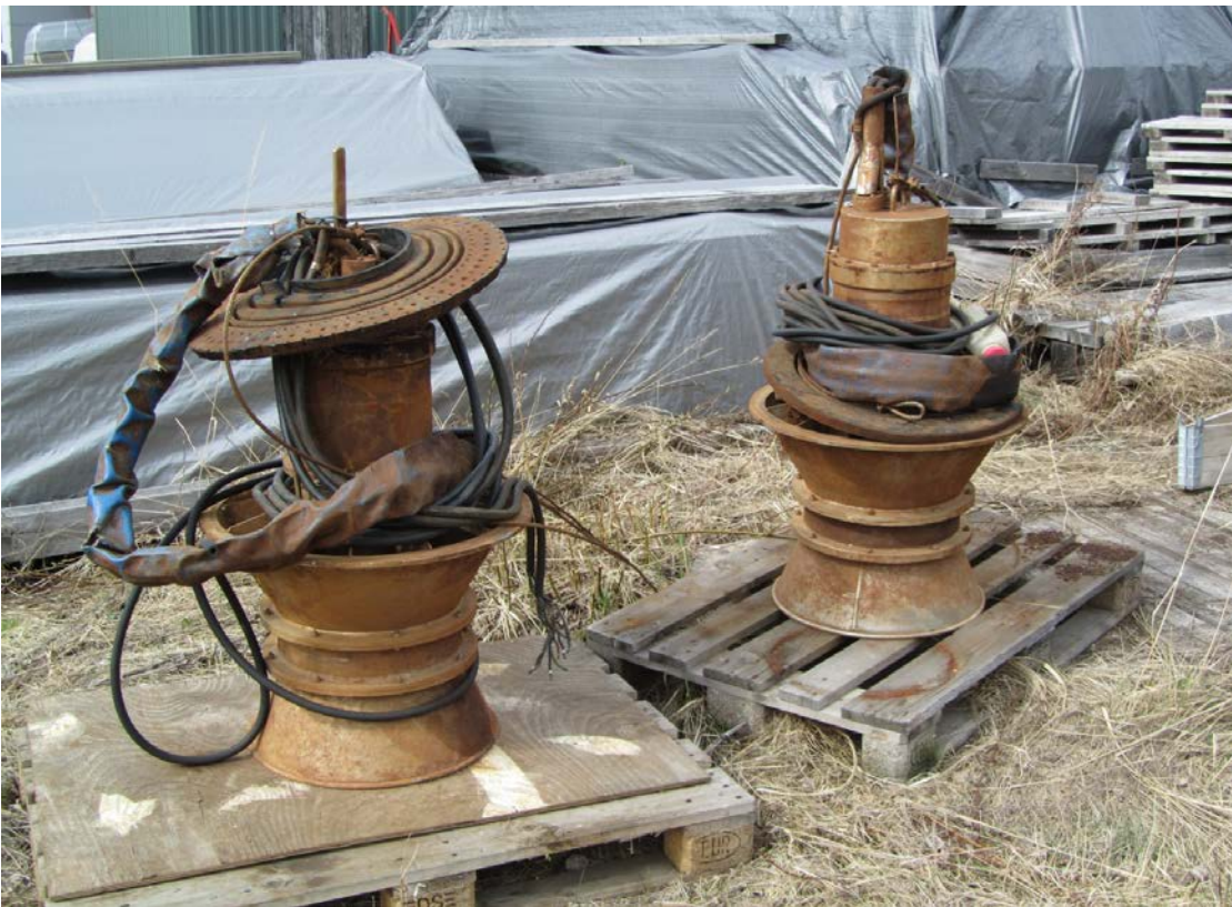
17. 2 kpl Waterpumps-potkuripumppuja. Vuosimalli 1994. Tuotto 250 l/s. Käyntikuntoisia.
