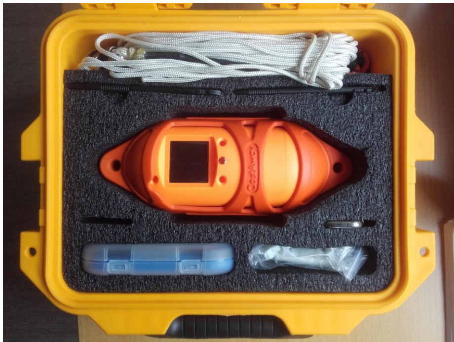
Kuva 2. Cast Away-sondi, joka mittaa veden lämpötilan, ominaissähkönjohtavuuden ja syvyyden.
