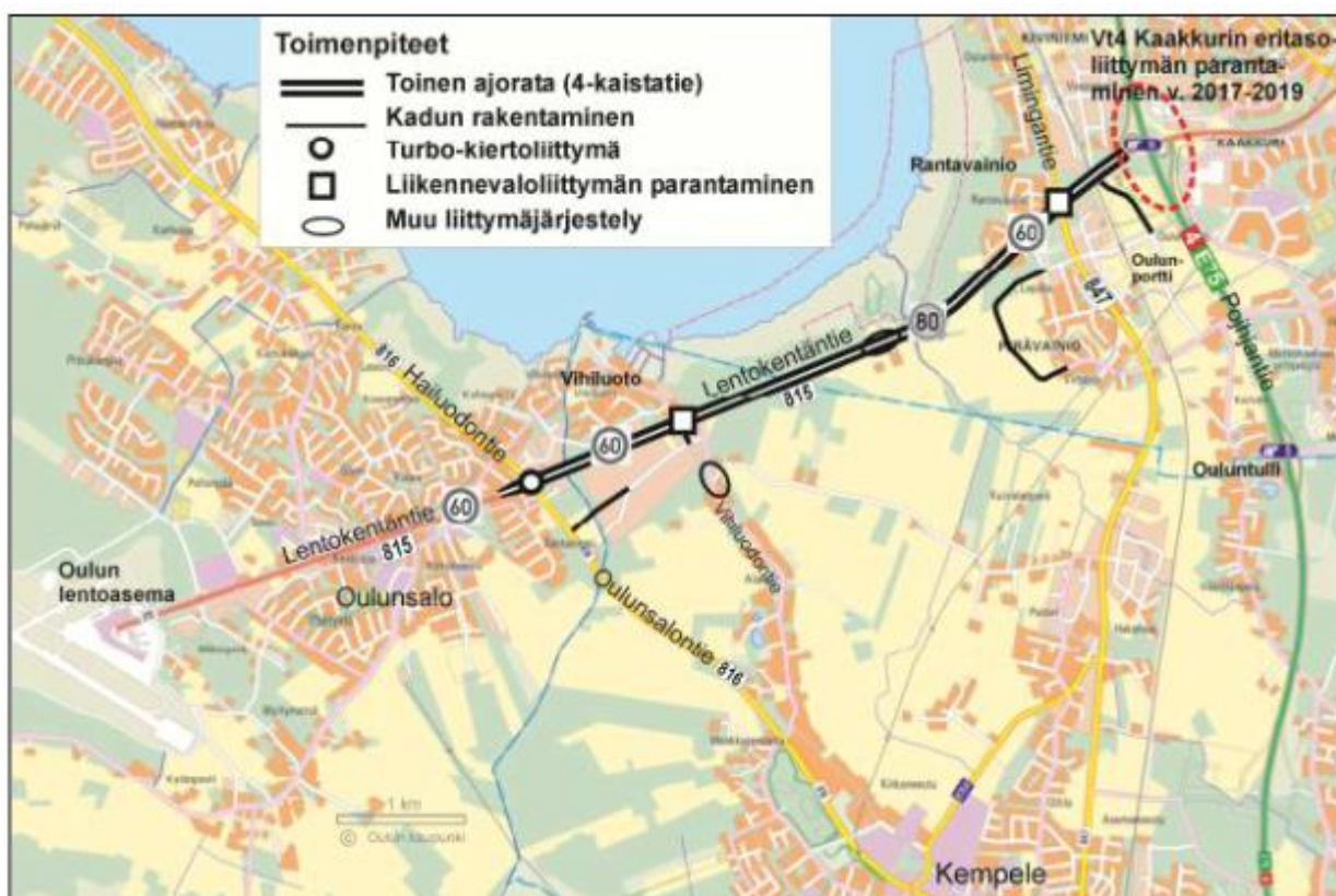
Kuva 19. Vaihtoehto VE1; nelikaistainen Lentokentäntie ja tasoliittymät. Lähde: Mt 815 Lentokentäntien kehittämisselvitys välillä Hailuodontie (Mt 816) – Pohjantie (Vt 4) (ELY-keskuksen raportteja 28/2017)
