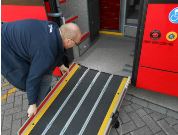
Kuva 5. Kuljettaja kiinnittää ja irrottaa pyörätuolirampin.
