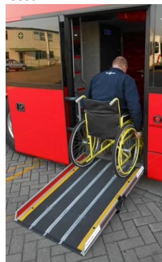
Kuvat 1 ja 2. Pyörätuoliramppi ja leveä ovi matalalattiaosaan.
