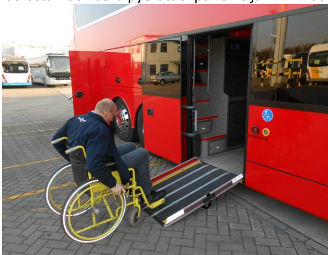
Kuvat 1 ja 2. Pyörätuoliramppi ja leveä ovi matalalattiaosaan.
