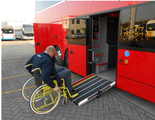
Kuvat 1 ja 2. Pyörätuoliramppi ja leveä ovi matalalattiaosastoon.
