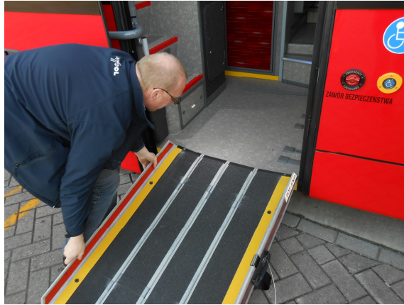
Kuva 5. Kuljettaja kiinnittää ja irrottaa pyörätuolirampin.
