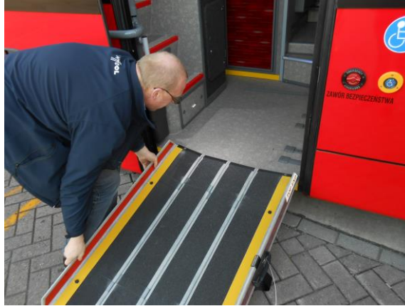
Kuva 5. Kuljettaja kiinnittää ja irrottaa pyörätuolirampin.
